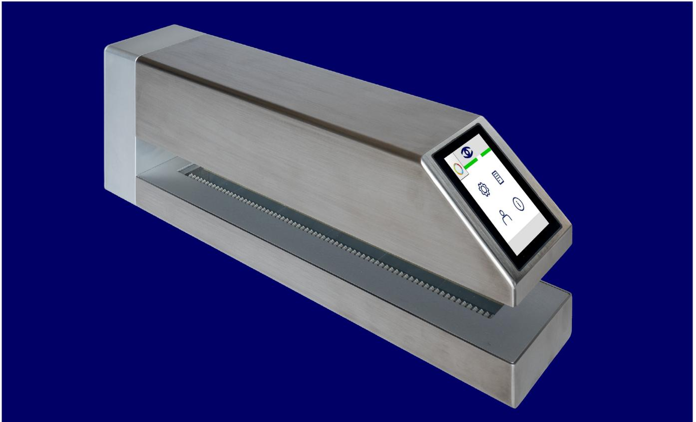
**PATERA FOCON** dient der optoelektronischen Erkennung von Poren und Rissen in Aluminiumfolie auf Blister- und Stickpack-Maschinen. Das System wird zwischen Form- und Füllstation quer zur Laufrichtung der Folienbahn installiert.
