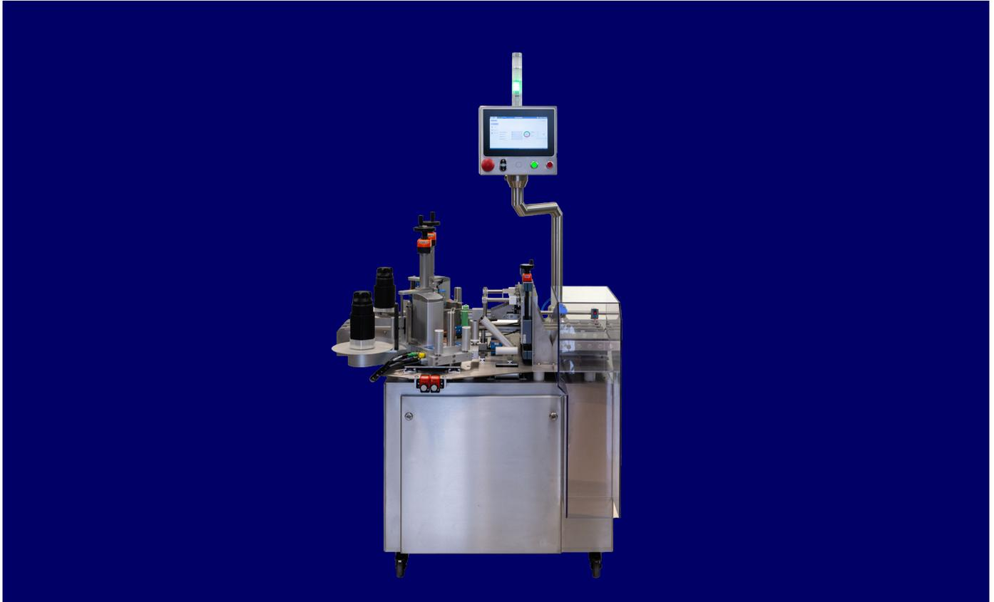
An der Tamper-Evidence Station CAPA TE
