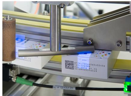
Hohe Positioniergenauigkeit der Etiketten durch präzise Faltschachtelführung
