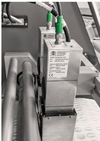
Die im Druckverfahren verwendeten Luminophore werden für die Emittierung der Sichtbarkeit verwendet, um eine maschinelle Auswertung zu ermöglichen, sodass die aufeinander abgestimmte Kamera und Beleuchtungseinheit die Wellenlängen des emittierten Lichts sicher erfassen und auswerten können.
