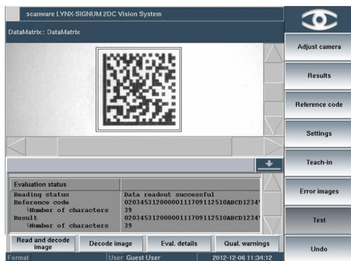
Die Auswertung von fehlerhaften Codes weist deren Abweichung genau aus. Dadurch können Fehler schneller abgestellt und weitere Auswürfe vermieden werden.
