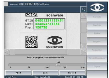
Das OCR-System ist vollkommen formatabhängig. scanware nutzt eine merkmalsbasierte Erkennung. Das zu prüfende Element wird anhand von beispielsweise Größe und Schwerpunkt analysiert.
