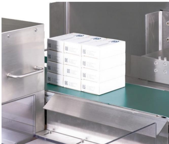
Kontrolle von Barcodes und 2D-Codes auf Faltschachteln, die in zu einem Bündel zusammengefasst wurden. Prüfung einzelner Faltschachteln ist ebenfalls möglich.
