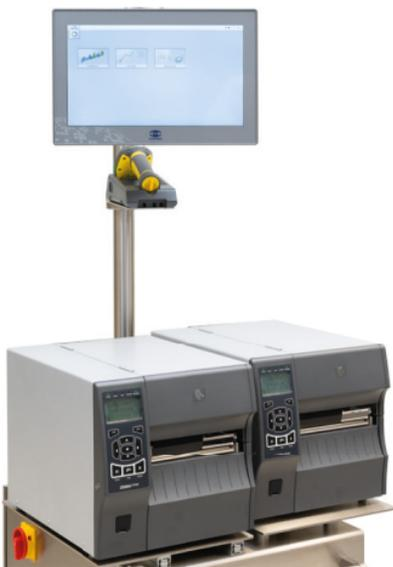
Labels werden mit produktionsspezifischen Daten bedruckt und anschließend überprüft. Je nach Anforderung kann das System für die manuelle Aggregation von Versandkarton oder Paletten sowie als Reworkstation verwendet werden.
