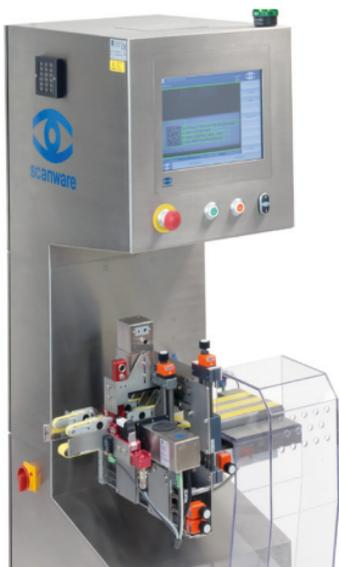
Faltschachteln werden mit produktionsspezifischen Daten bedruckt und diese anschließend überprüft. Die Verarbeitung und Aggregation von serialisierten Daten wird durch IMPERA Linienmanagement umgesetzt.
