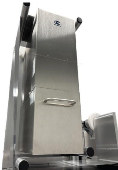
Graustufensystem zur Kontrolle des Druckbilds (OCR) auf Verpackungen im laufenden Prozess an der Linie.
