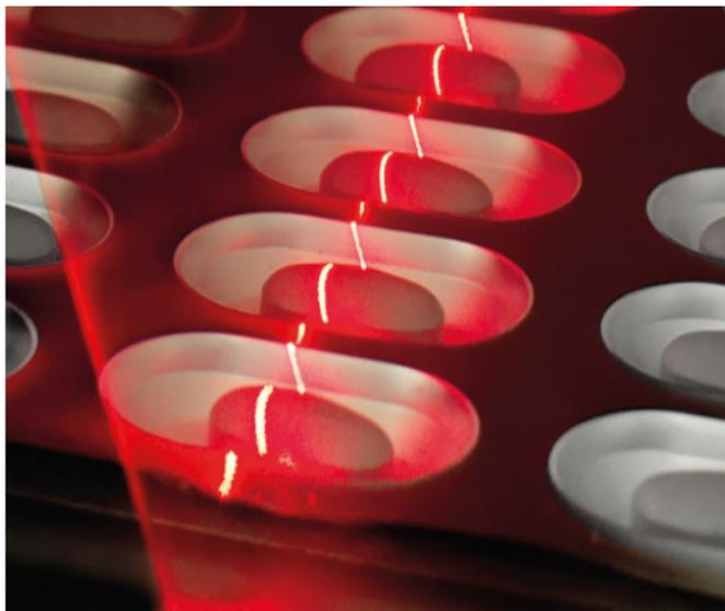
Hochauflösendes, lasergestütztes System zur Kontrolle der Geometrie von Folie und Produkt auf Druckstellen, Ausbuchtungen oder Abplatzungen.
