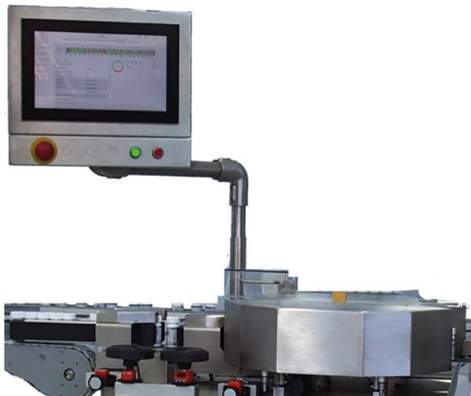
360°-Kontrolle sowie Aufdruck und Lesen von 2D und Helfercodes auf pharmazeutischen, wiederverschließbaren Plastikflaschen. Der korrekte Sitz von Flaschendeckel und -etikett wird ebenfalls geprüft.
