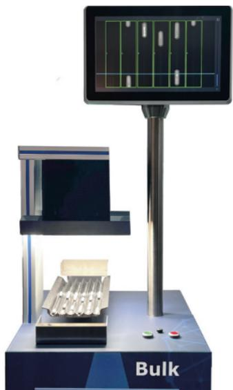
Mehrfache Prüfung jedes Produkts auf einer Bulk-Maschine zur Erkennung von Fremdprodukt, Fremdkörpern und Bruchstücken.
