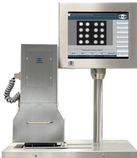
Farb-Produktkontrolle zur Erkennung von Untermischung, Größe, Fläche, Lage, Bruchstücken und Überfüllung.
