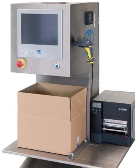
Kontrolle von Druckbildern von Faltschachteln oder Bündeln in einem Case, mit Verarbeitung und Aggregation von serialisierten Daten.
