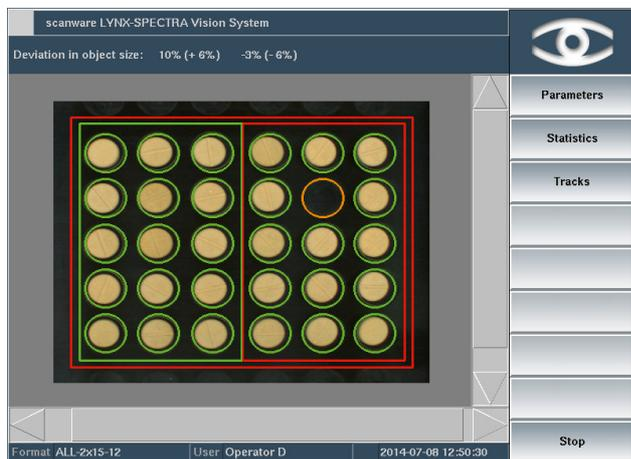
Bei intermittierenden Maschinen variiert der Triggerzeitpunkt abhängig von der Bandgeschwindigkeit und anderen technischen Faktoren. Diese werden durch die automatische Maskennachführung ausgeglichen.
