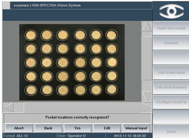
Die Automatisierung des Einlernprozesses vereinfacht das Einlernen und ermöglicht es so, schnell in die Produktion überzugehen. Dabei werden Objektposition, Blistergeometrie und Produktfarbe automatisch erkannt. Daneben ist auch ein manueller Lernlauf möglich.
